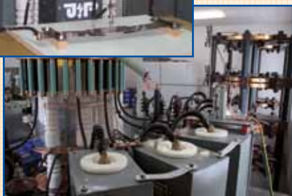
Prüflabor mit Stoßstromanlage (10/350 \mu s)
