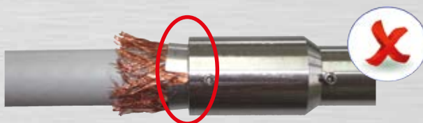
53. ábra: Az alsó csatlakozó idom és az érintkezőlemez helytelen beigazítása
