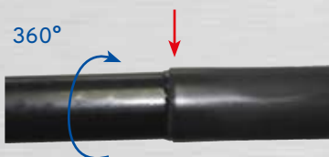
38. ábra: Ragasztókifolyás a fekete rétegnél
