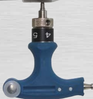
30. ábra: Húzza meg az A hernyócsavart 4 Nm nyomatékkal
