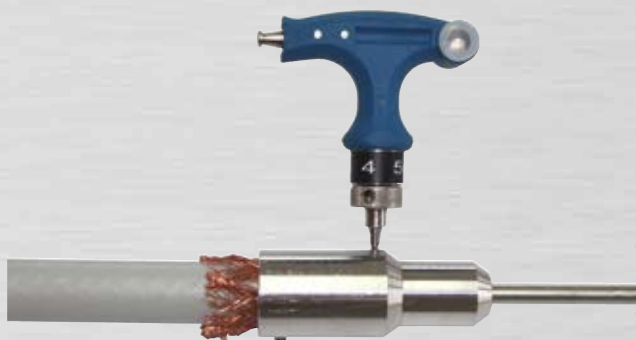
55. ábra: Húzza meg a B hernyócsavart 4 Nm nyomatékkal
