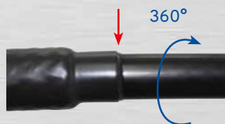
35. ábra: Ragasztókifolyás a fekete rétegnél
