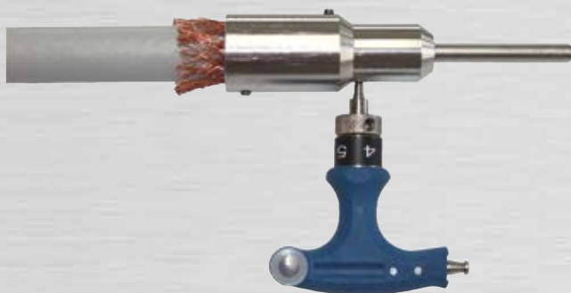
54. ábra: Húzza meg az A hernyócsavart 4 Nm nyomatékkal
