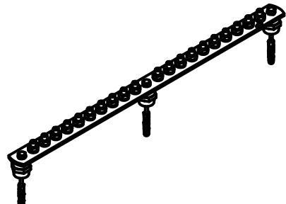
Zum Anschließen in explosionsgefährdeten Bereichen der Zonen 2/22 geeignet. Die Anschlüsse der Potentialausgleichsschiene sind wie nach DIN EN 62305-3 Beiblatt 2 gegen Selbstlockern durch einen Federring gesichert.
