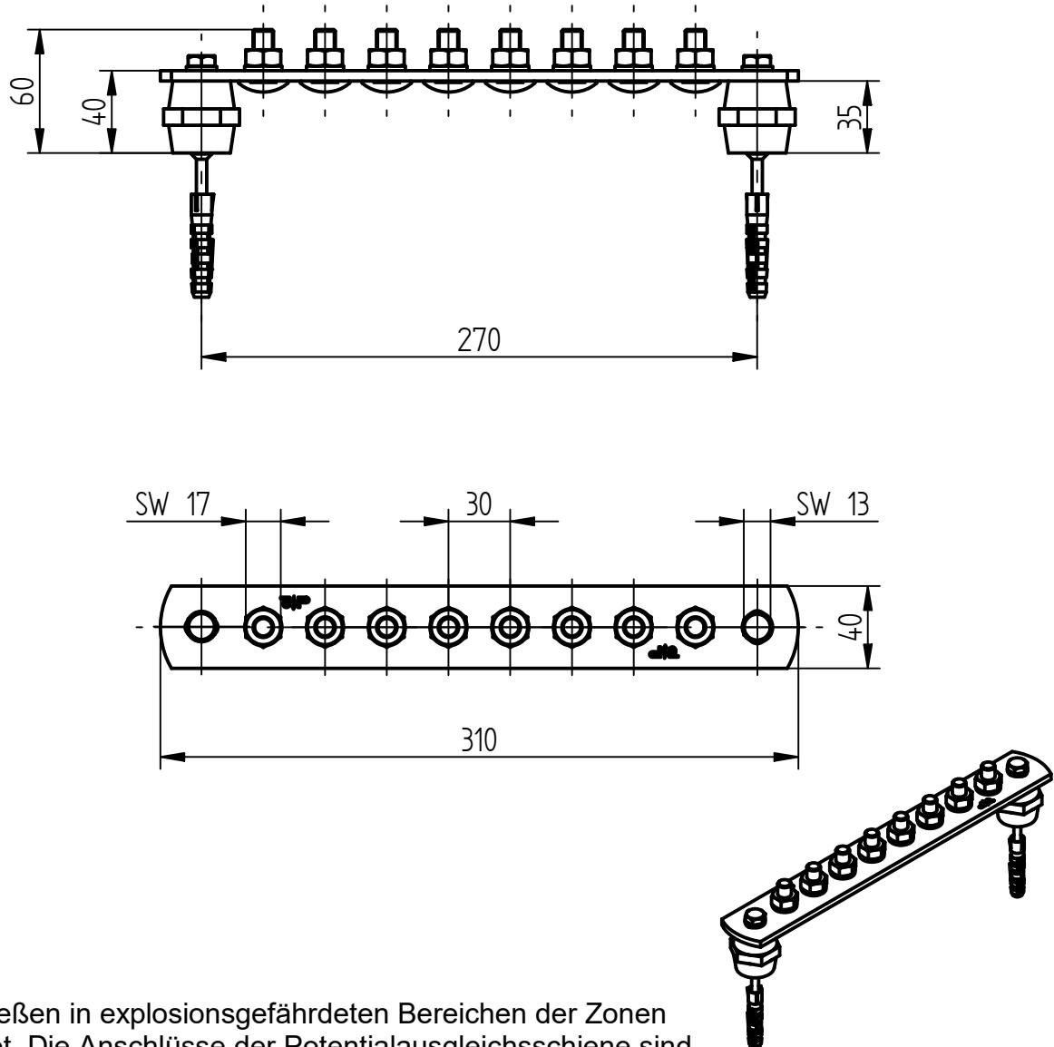
Zum Anschließen in explosionsgefährdeten Bereichen der Zonen 2/22 geeignet. Die Anschlüsse der Potentialausgleichsschiene sind wie nach DIN EN 62305-3 Beiblatt 2 gegen Selbstlockern durch einen Federring gesichert.
