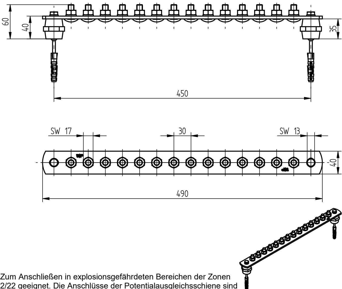
Zum Anschließen in explosionsgefährdeten Bereichen der Zonen 2/22 geeignet. Die Anschlüsse der Potentialausgleichsschiene sind wie nach DIN EN 62305-3 Beiblatt 2 gegen Selbstlockern durch einen Federring gesichert.
