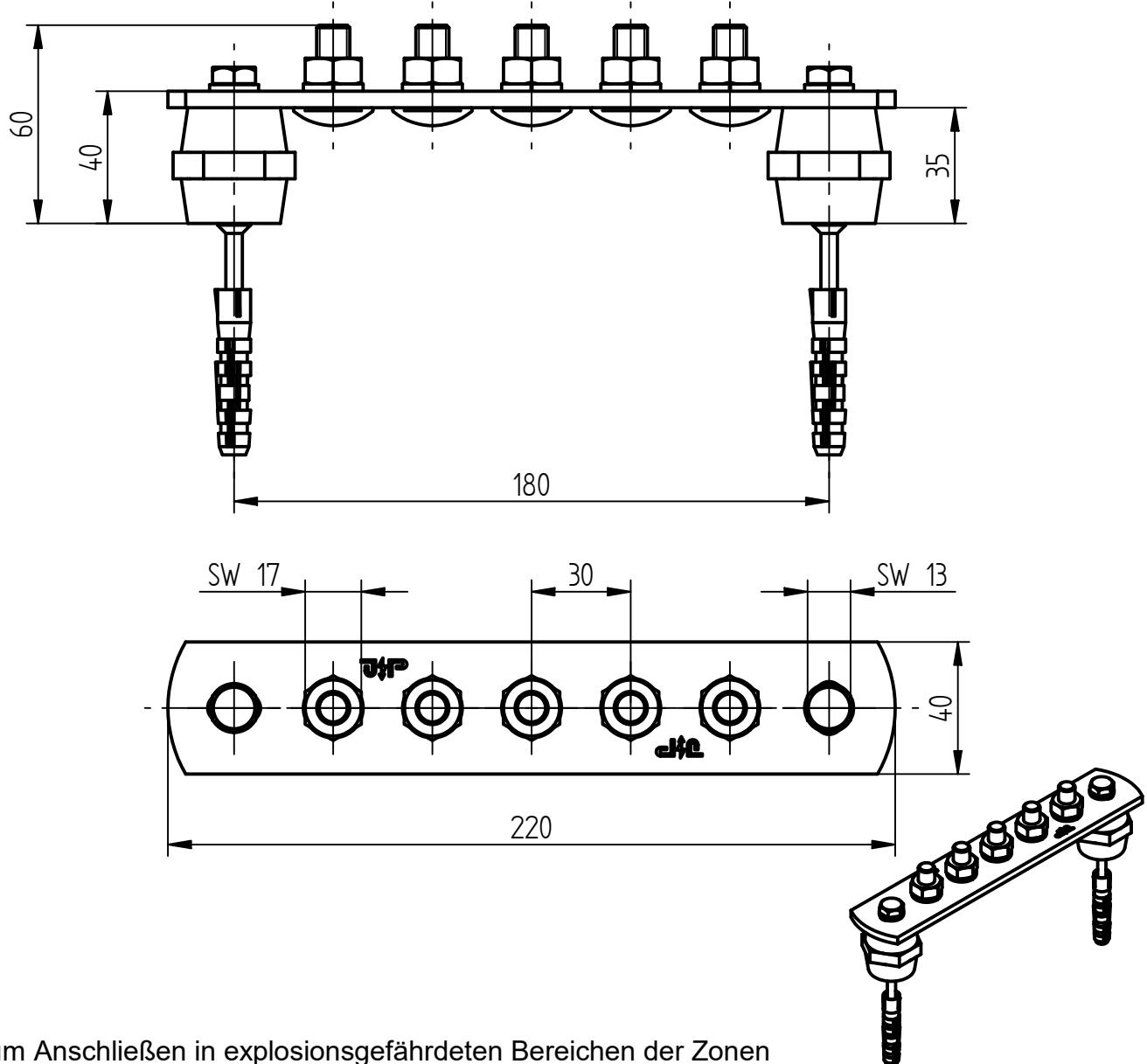
Zum Anschließen in explosionsgefährdeten Bereichen der Zonen 2/22 geeignet. Die Anschlüsse der Potentialausgleichsschiene sind wie nach DIN EN 62305-3 Beiblatt 2 gegen Selbstlockern durch einen Federring gesichert.
