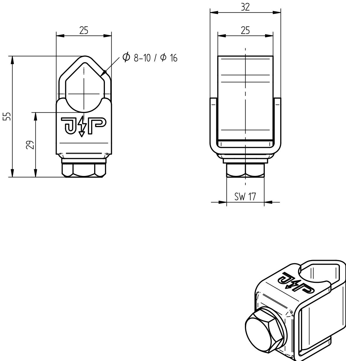
Zum Anschließen in explosionsgefährdeten Bereichen der Zonen 2/22 geeignet.
