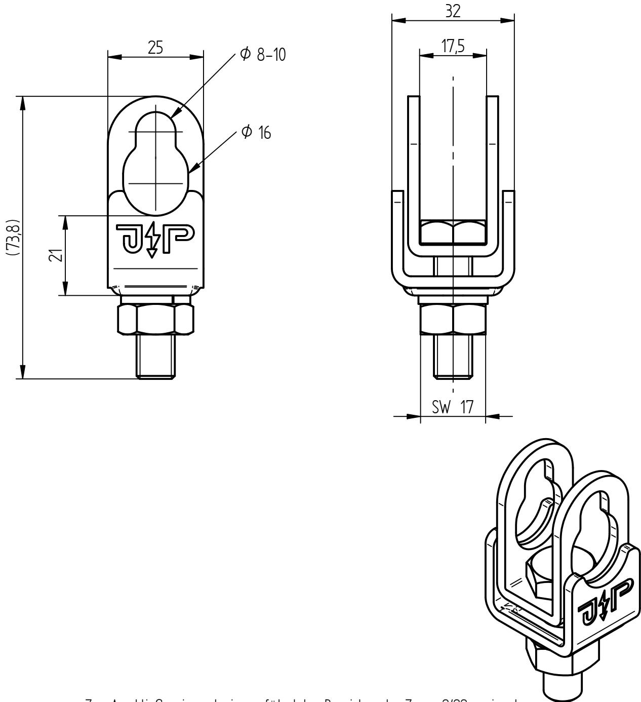
Zum Anschließen in explosionsgefährdeten Bereichen der Zonen 2/22 geeignet.
