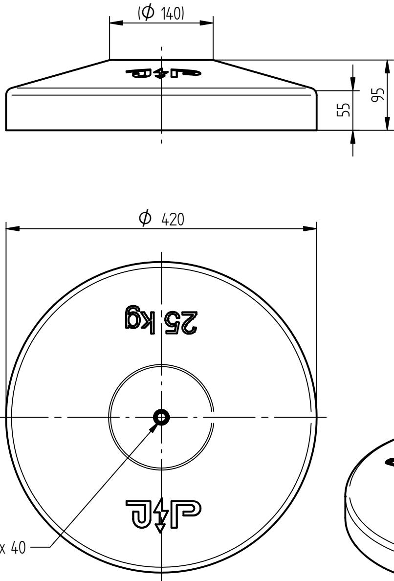
Bei Foliendächern ist eine Unterlegplatte für Betonsockel dringend erforderlich.
