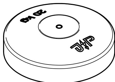
Bei Foliendächern ist eine Unterlegplatte für Betonsockel dringend erforderlich.
