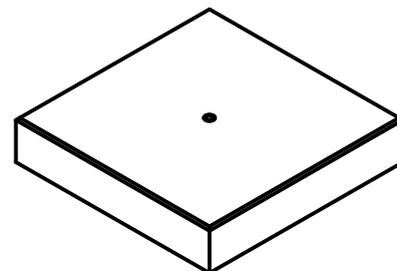
Bei Foliendächern ist eine Unterlegplatte für Betonsockel dringend erforderlich.
